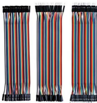
Figura 4. Cables pont: mascle-masclle (esquerra), mascle-femella (centre) i femella-masclle (dreta).
