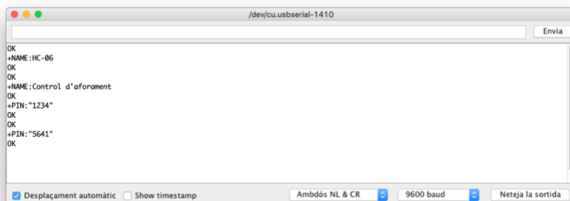
Figura 52. Configuració del mòdul Bluetooth a través del monitor sèrie.
