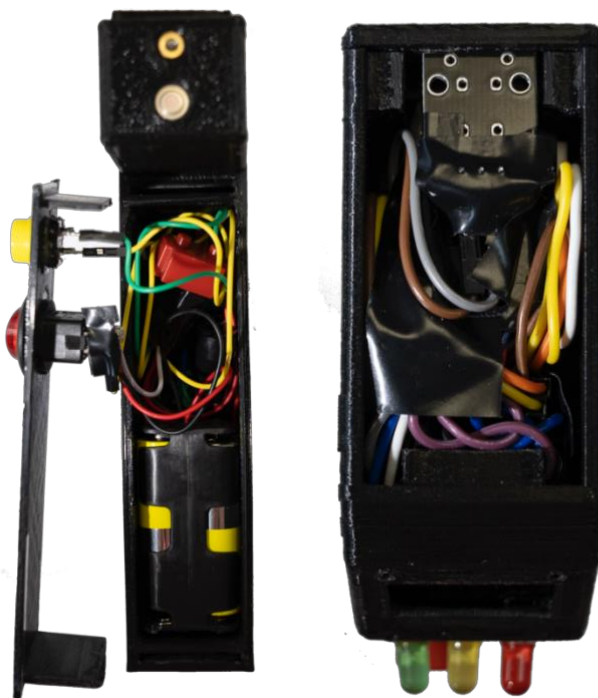
Figura 68. Cablejat intern del termòmetre infraroig digital.
