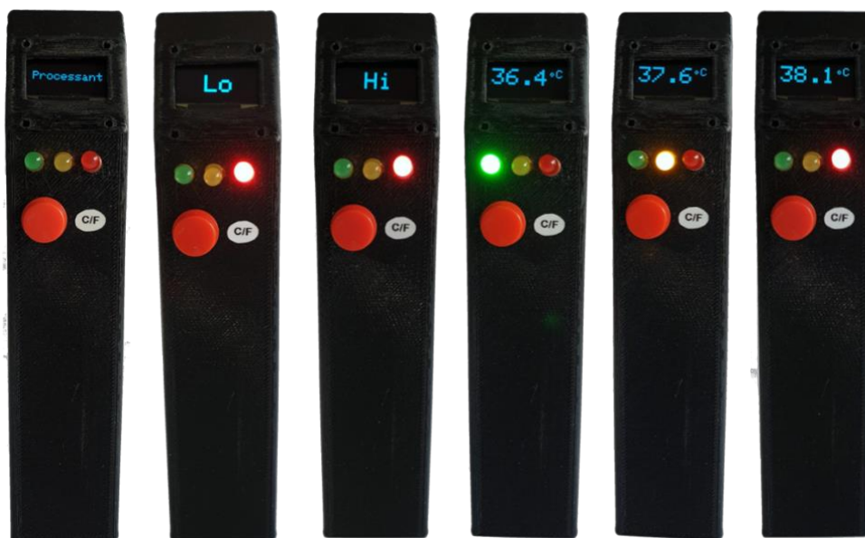
Figura 70. Galeria de pantalles i encesa dels díodes LED (termòmetre infraroig digital).
