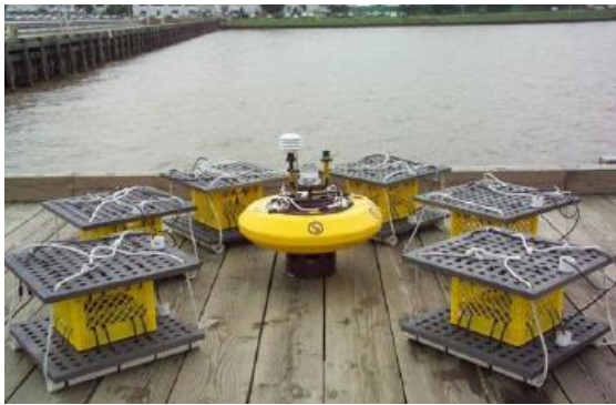
Imatge 18: Boia- sensor alimentat per una MFC. Font: Ptolomeu unam
