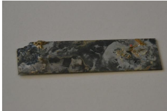
Imatge 17: Elèctrode anòdic de zinc al finalitzar l'experiment. S'observa una forta corrosió. Font: Pròpia
