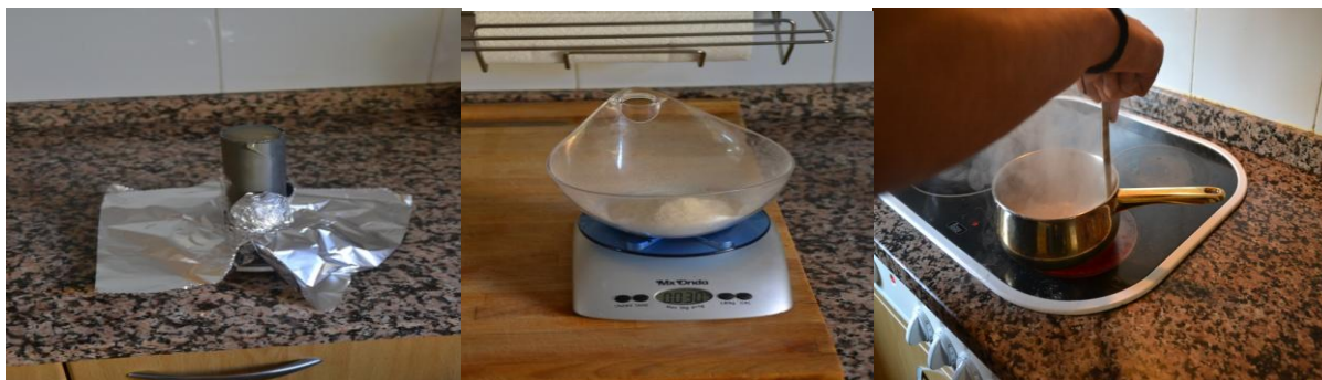
Imatge 25: Elaboració del pont salí. Font: Pròpia
