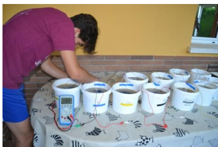
Imatge 34: Imatges de les cel·les connectades en sèrie. Font: Pròpia
