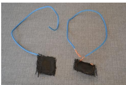
Imatge 24: Construcció de l'ànode Font: Pròpia
